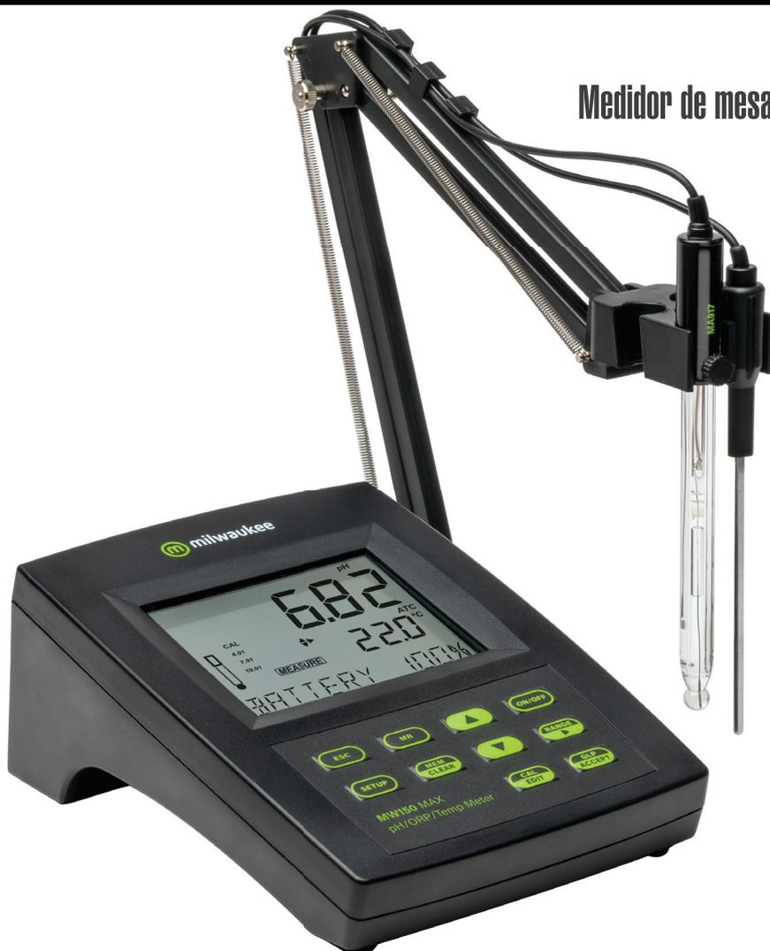
El **MW150 MAX** es un medidor de pH/ORP/Temp basado en un microprocesador. Es ideal para estudiantes y técnicos que necesitan mediciones rápidas y fiables.
