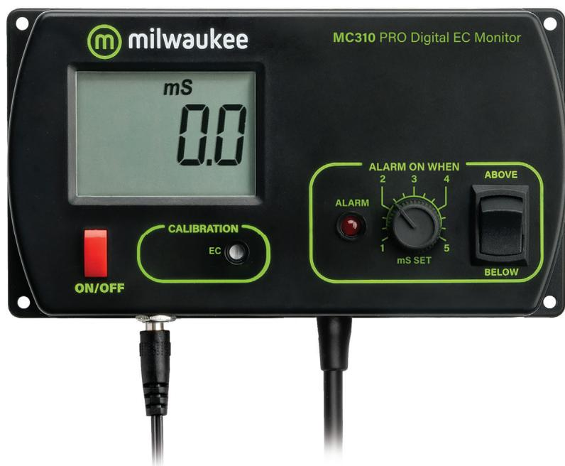
Medidor de conductividad con compensación automática de temperatura, un punto calibración manual y un adaptador 12 VDC para la corriente. Ideal para el sector hidropónico; Permite controlar los valores de la EC de su tanque de forma continua. Otras características: Punto de consigna ajustable, LED de alarma visual para cuando los valores pasan encima / debajo del punto de consigna (seleccionable con el botón Above / Below)
