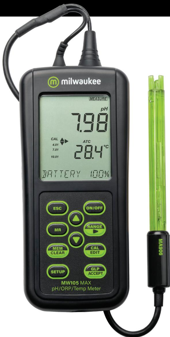
El medidor Milwaukee MW105 MAX combina todas las características de un medidor de sobremesa en un medidor portátil con clasificación IP67. Los instrumentos cuentan con una serie de nuevas características de diagnóstico para mejorar la fiabilidad de las mediciones de pH:
